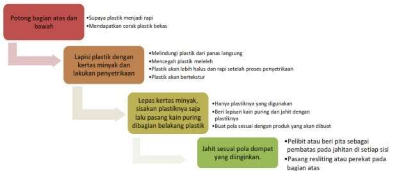
Gambar 1. Diagram alir pembuatan dompet dari sampah plastik
