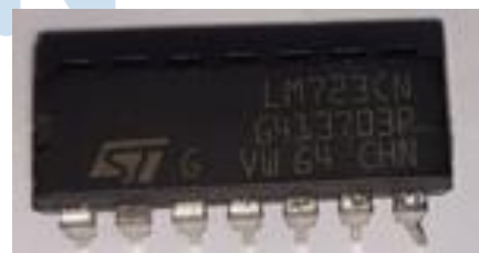
Gambar 3. Bentuk Fisik IC LM723
