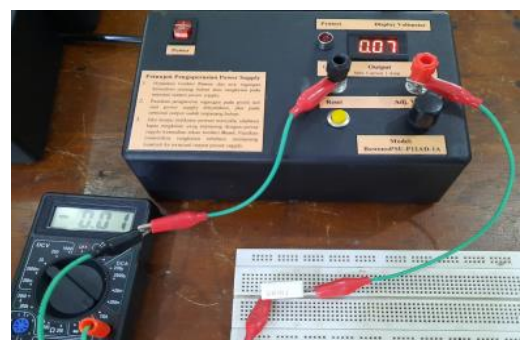
Gambar 12. Konfigurasi pengujian power supply
