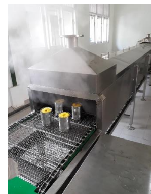
Gambar.3.Manisan Carica Kaleng dan Mesin Sterisasi Otomatic
