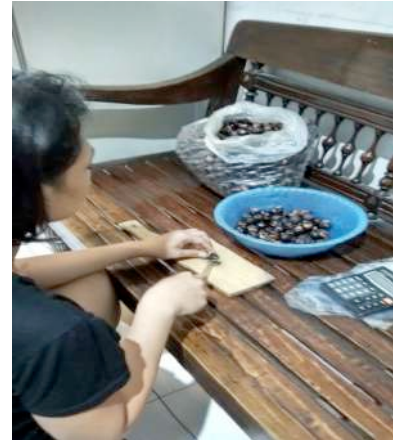
Gbr 3. Proses pemotongan lerak sebelum dikeringkan
